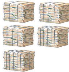
Somos los únicos que ofrecemos fijación de balas en una compactadora multicámara. Las balas se sujetan bajo presión con 2-6 correas en función del material y los requisitos de manipulación de las balas.
